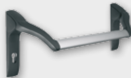
Paniekbalk aluminium matzwart met stalen onderbouw, handgreep geanodiseerd aluminium EV 1, toepasbaar voor deuren met een breedte van maximaal 1300 mm, rechts/links toepasbaar, te combineren met beslag volgens DIN 18273
